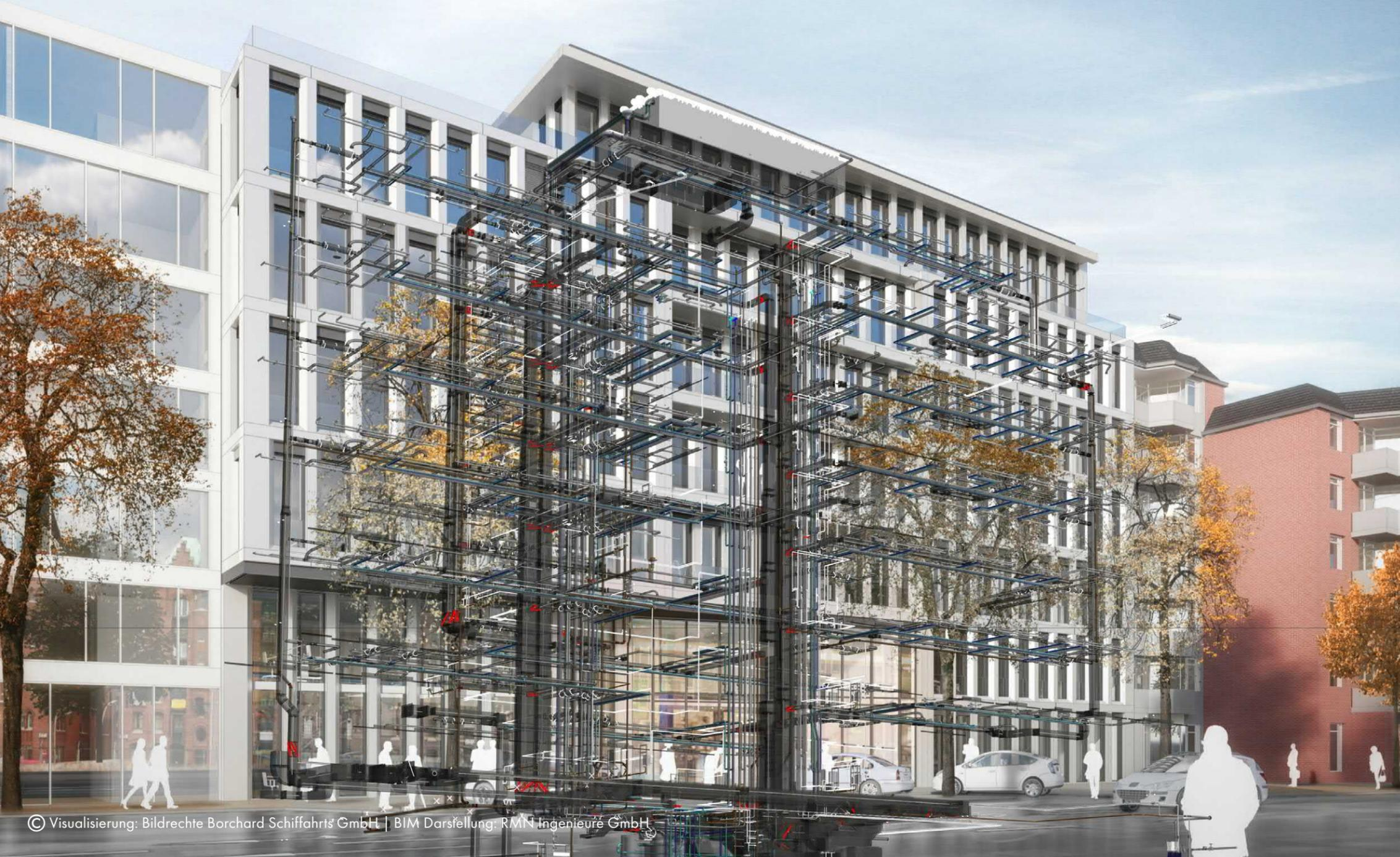
Planungszukunft in BIM: Mit dem Revit-Modell lässt sich die Technische Gebäudeausrüstung hinter der Fassade des Bürogebäudes „Bei den Mühlen“ umfassend und dreidimensional darstellen. Alle relevanten und technischen Daten liegen in der zugehörigen Datenbank zur weiteren Nutzung bereit.
